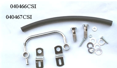
Cross over da utilizzare quando si usano filtri custom sprovvisti di appositi attacchi: 040466CSI per XL Sportster dal 91 in su OEM 29281-91T 040467CSI per B-T evolution dal 93 in su OEM 29310-93
