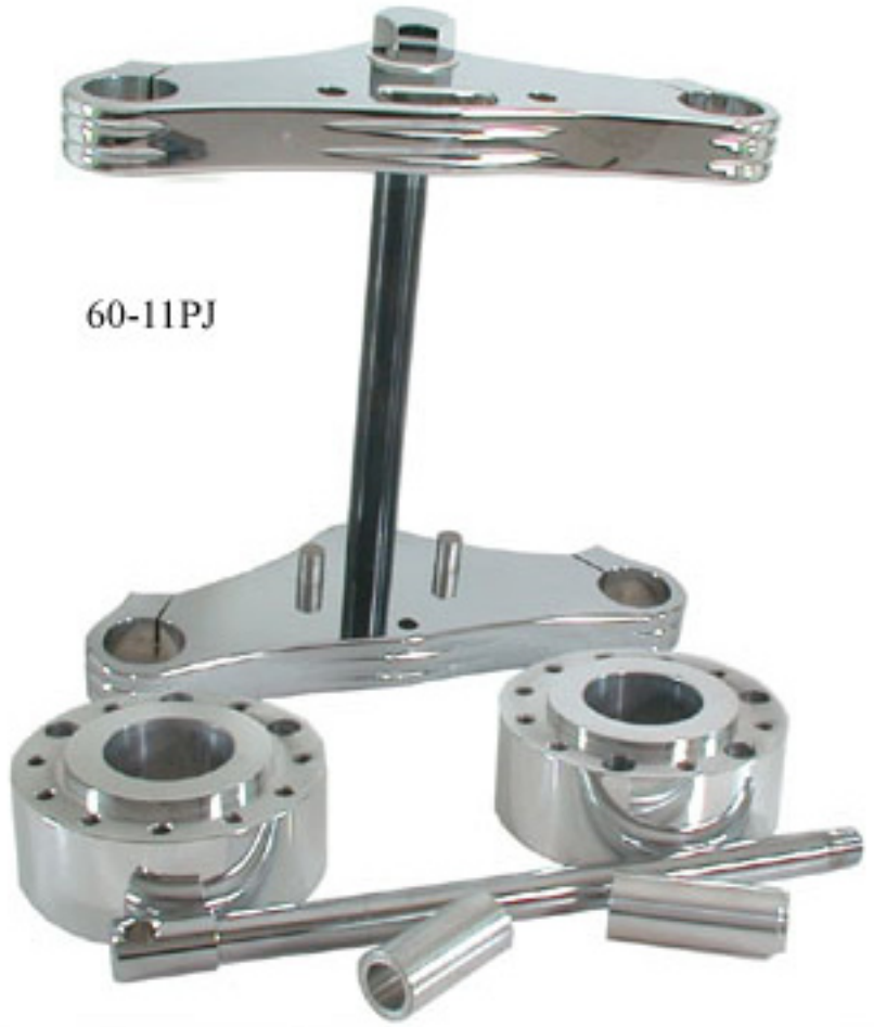
Piastre per Guzzi con canne da 38mm diritte non inclinate.
